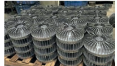
Anschließend erfolgt die Anodisierung der Oberfläche und die Färbung mit dem gewünschten Farbton.
