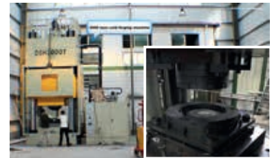
Jede Scheibe wird in einer 3000-Tonnen-Press platziert.
