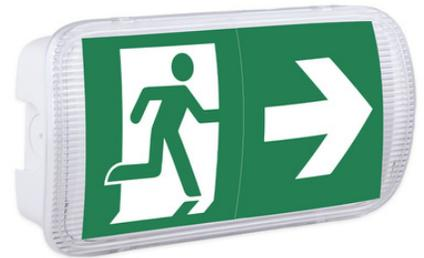
Die Not-LED-Leuchte **Shield P** mit einer Leistung von 1 W erzeugt einen Lichtstrom von 150 lm (ohne aufgeklebtes Piktogramm). Die Leuchte ist zur **Markierung der Fluchrichtung mit einer Erkennungsweite von 20 m** bestimmt und kann sowohl im **Standby- als auch im Dauerbetrieb** arbeiten, d. h. sie leuchtet bei Stromausfall der regulären Beleuchtung und kann zusätzlich auch dauerhaft bei funktionierender Beleuchtung eingeschaltet sein.
