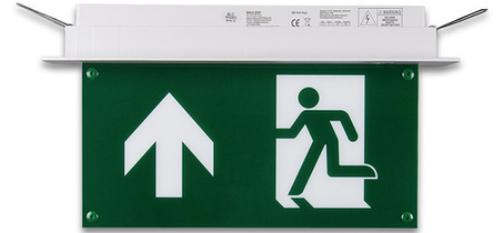
Die Not-LED-Piktogrammeleuchte **Sign P** mit einer Leistung von 2 W erzeugt einen Lichtstrom von 60 lm. Die Leuchte ist zur **Markierung der Fluchrichtung** mit einer **Erkennungsweite von 20 m** bestimmt und kann sowohl im **Standby- als auch im Dauerbetrieb** arbeiten, d. h. sie leuchtet bei Ausfall der regulären Stromversorgung und kann zusätzlich auch dauerhaft bei funktionierender Beleuchtung eingeschaltet sein.
