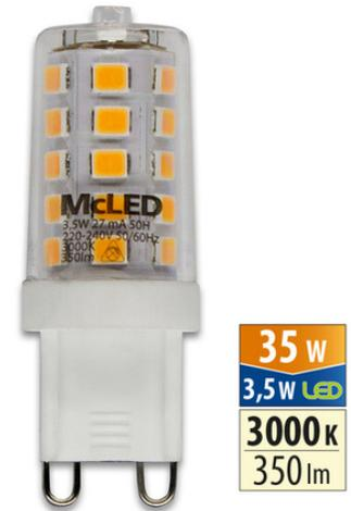
Die sparsame LED-Kapsel von McLED mit Leistungsaufnahme von nur **3,5 W** ersetzt mit ihrer Leistung vollständig eine klassische 35 W-Halogen-Kapsel (Gesamtlichtstrom 350 lm). Diese LED-Kapsel mit Sockeltyp G9 wird genauso wie die klassische Kapsel an 220 - 240 V (AC) angeschlossen.
